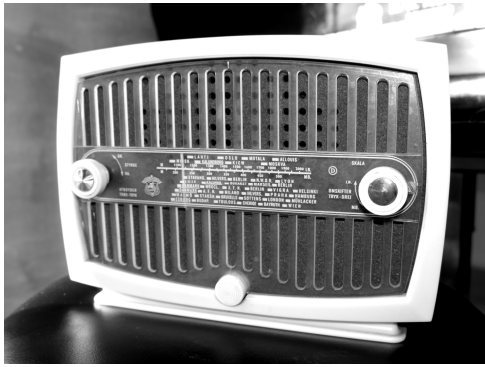
Herofon Bambino af samme model, som den, jeg i 1964 købte brugt hos Dahls Radio for 175 kr. Modellen var i 1958 fremstillet på Herofon-fabrikken i Horsens og kunne modtage på lang- og mellembølge. Den havde kostet 295.- fra ny.
